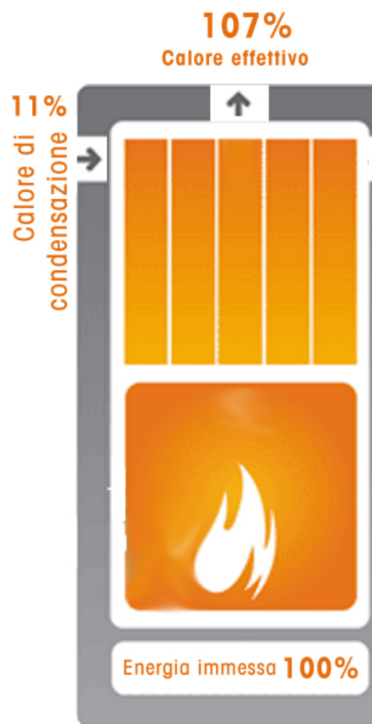
Caldaia a condensazione
